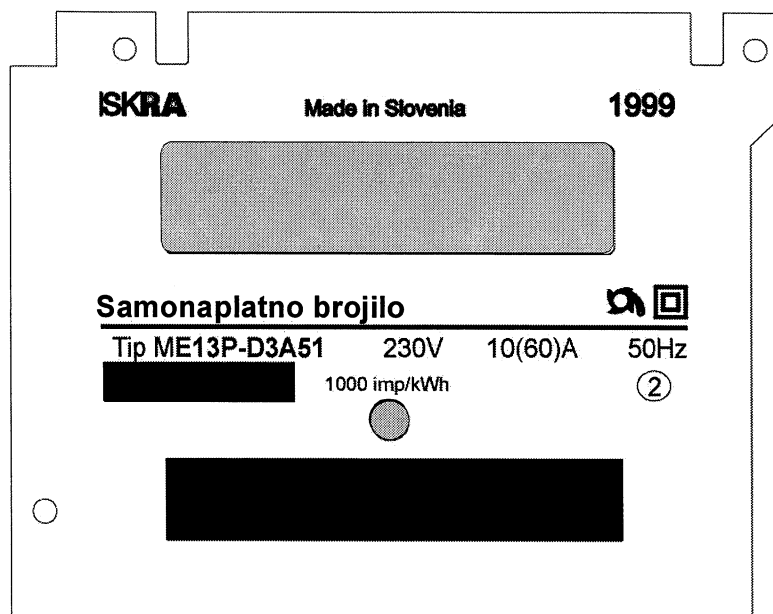
SI. 5 Natpisna pločica mjerila ME13P
